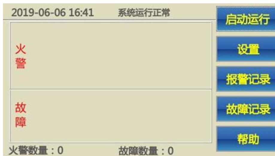
图 3.6 光纤温度分布测试仪主界面（未测试状态）
