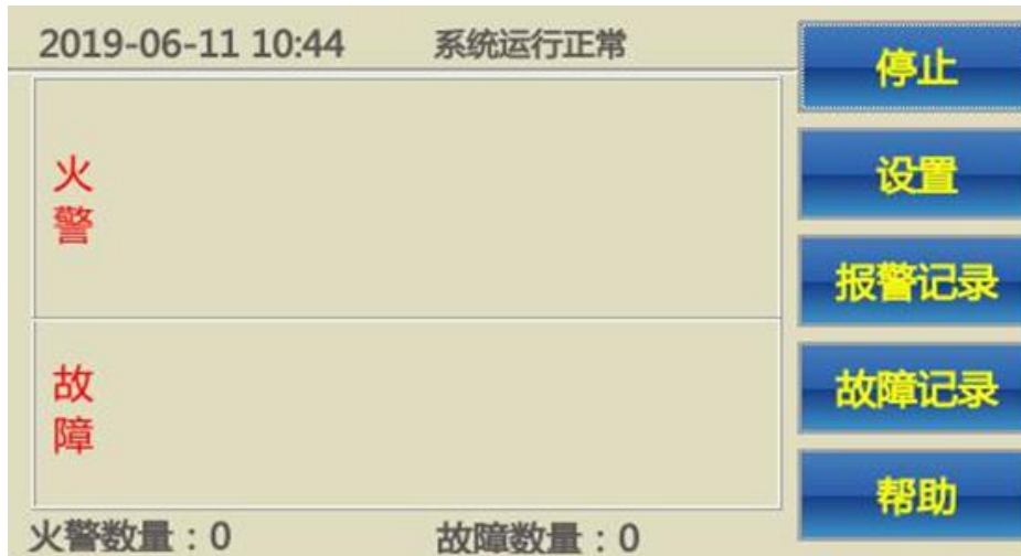
图 3.7 光纤温度分布测试仪主界面 (测试状态)
